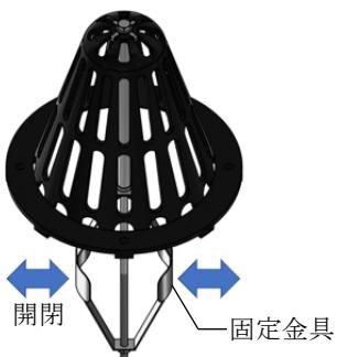
中央ネジ頭を回転させることによって固定金具を開閉させることができます。
