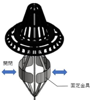
中央ネジ頭を回転させることによって固定金具を開閉させることができます。
