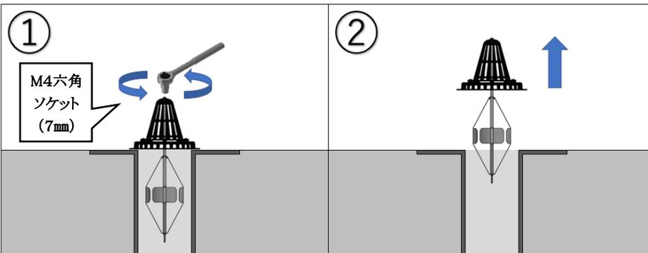
①ソケットレンチを用いて固定金具を緩める(反時計回り)。
