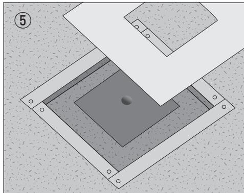
⑤ 塩ビシートを塩ビ鋼板の大きさに合わせて切る。
