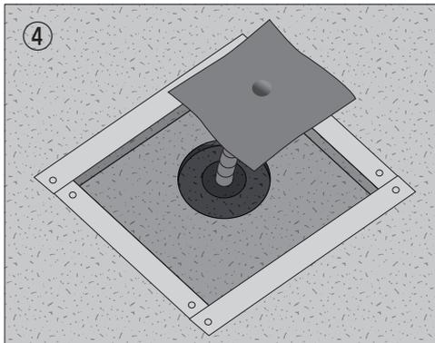
④ 待改修ドレン（塩ビ製）を既設ドレンに差し込み接着剤を用いて貼りつける。
