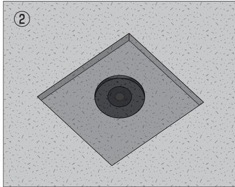
② 既設ドレンのストレーナ、防水層押さえ及び周囲の防水層を撤去する。
